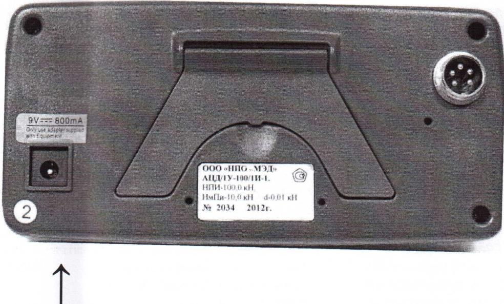
Рисунок 3. Схема пломбировки от несанкционированного доступа и обозначение места (2) для нанесения оттиска клейма.
