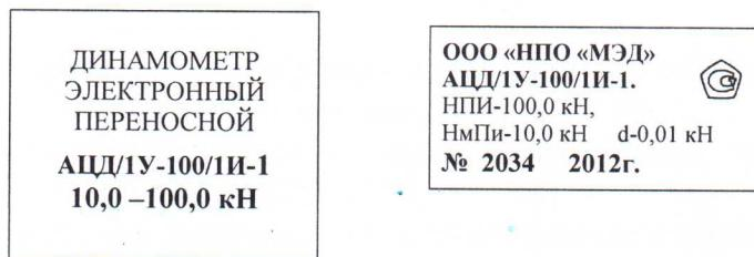
Маркировка динамометра на электронном блоке
